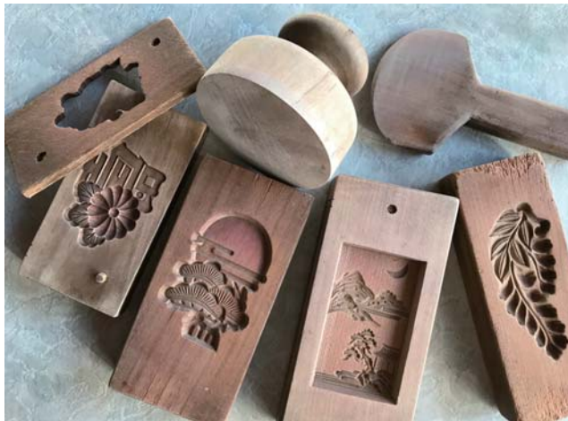
梅津菓子舗の落雁木型と駒の爪(上中央)とへう。へうはすり減って 3 分の 2 ほどになっている。写真上は左の木型で打ち出した落雁
